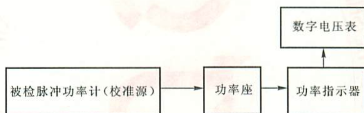
图 6 功率计校准源的输出功率电平检定框图
