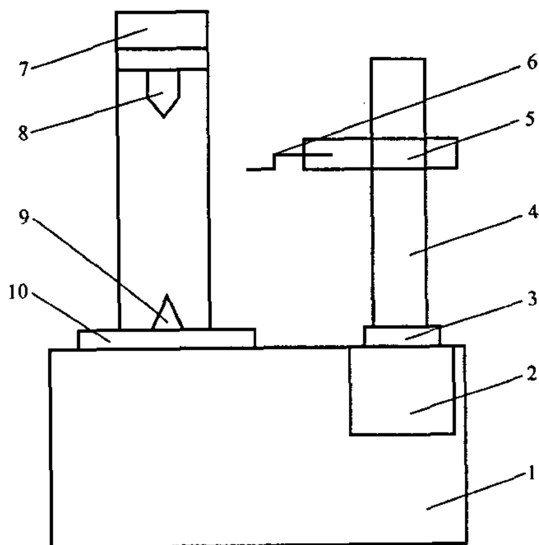
图 2 数控式齿轮测量仪
